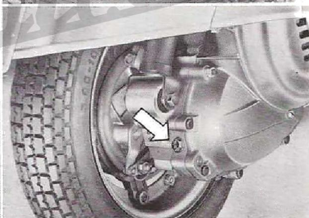
Fig. 10 - Oil draining hole «A» and filler «B».
